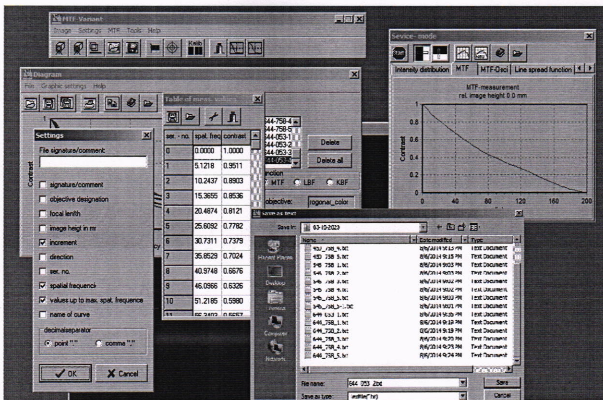
Рисунок 6 – Окна ПО «MTFVariant», позволяющие измерять, отображать и сохранять полученные результаты измерения
