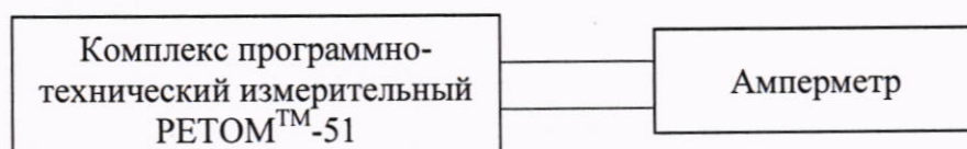
Рисунок 5 – Схема подключения амперметра при определении приведенной погрешности измерений (в диапазоне воспроизведения силы постоянного или переменного тока от 0 до 20 А включ.)
