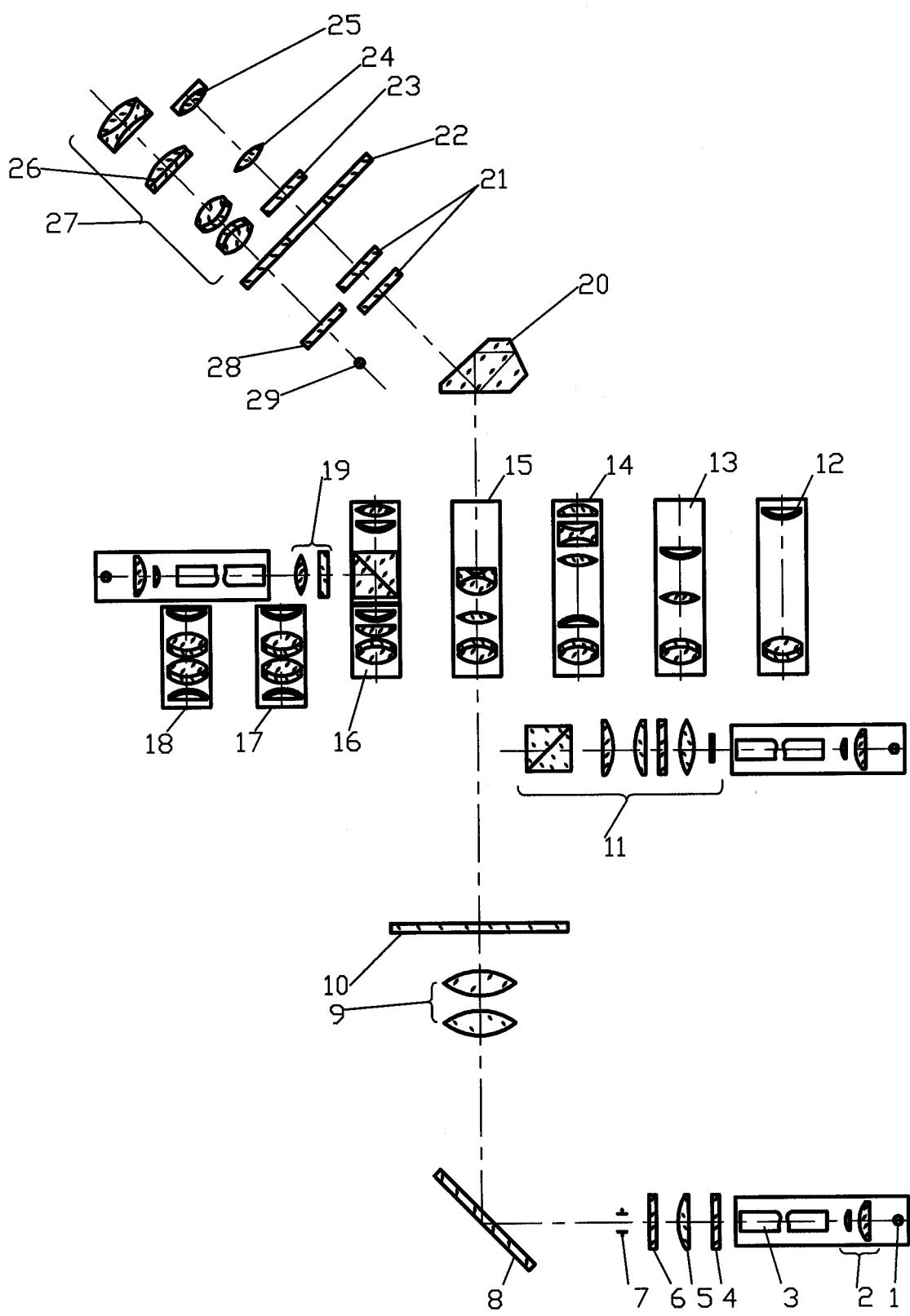
Лучи света от осветителя, состоящего из лампы 1, линз конденсора 2, световода 3, падает на светофильтр 4, линзу 5, матовое стекло 6, проходит через диафрагму 7, зеркало 8, конденсор 9 и освещает контур измеряемого объекта.
