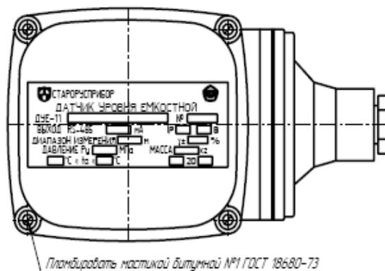
Рис.2. Место установки пломбы в датчиках ДУЕ-1-1, ДУЕ-1В-1
