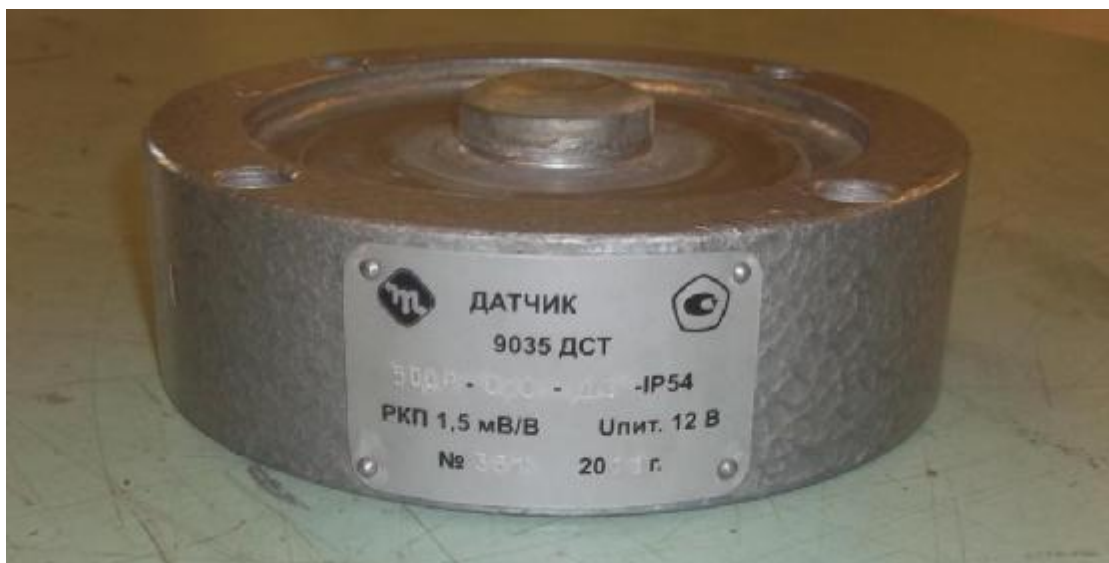
Рис. 1. Общий вид датчиков силоизмерительных тензорезисторных 9035 ДСТ
