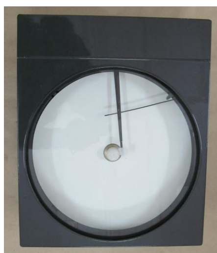
Рисунок 1 - Общий вид манометров дифференциальных сильфонных самопишущих и показывающих ДСС и ДСП с местом пломбировки
