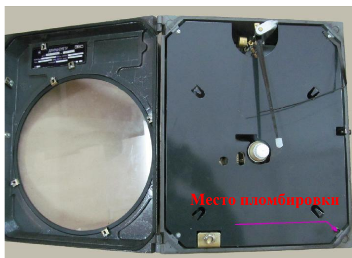
Рисунок 1 - Общий вид манометров дифференциальных сильфонных самопишущих и показывающих ДСС и ДСП с местом пломбировки
