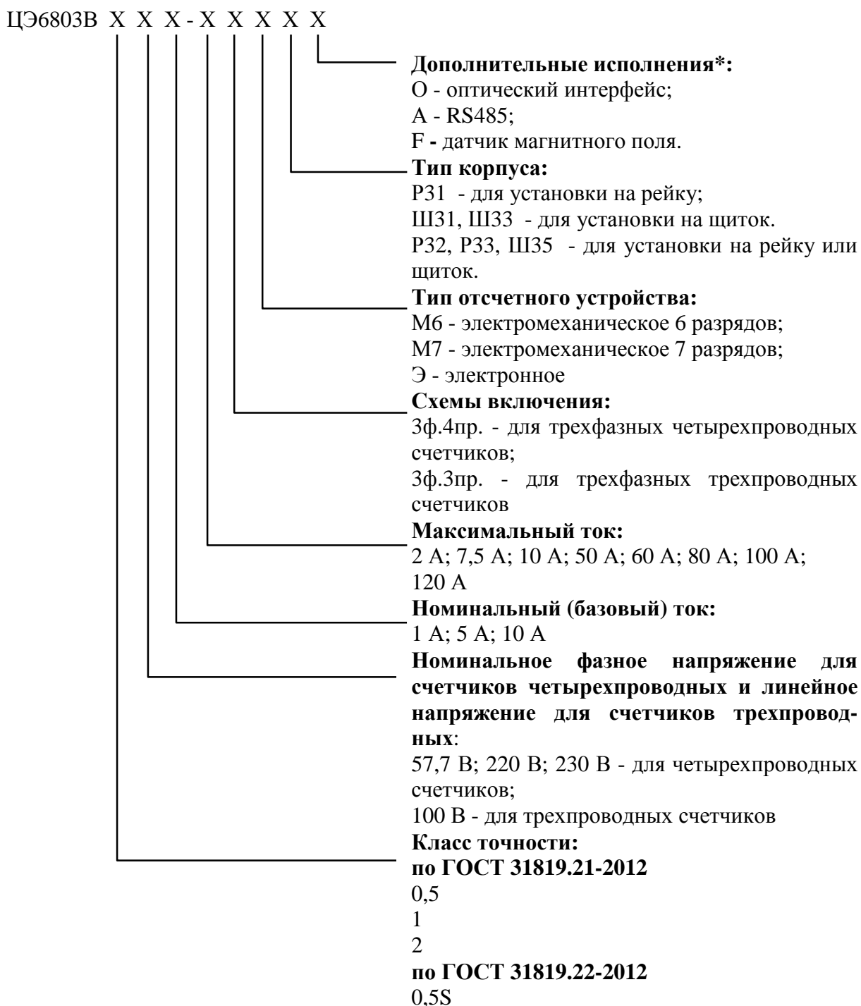
Рисунок 1 - Структура условного обозначения счетчиков
