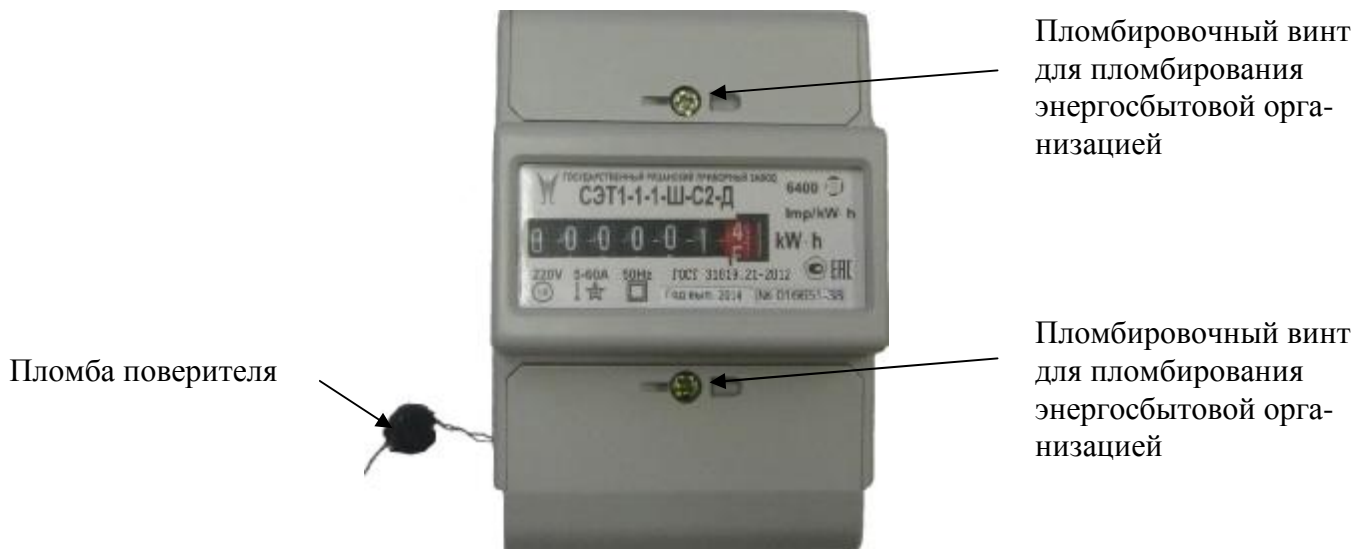
Рисунок 2 Фотография внешнего вида счетчиков СЭТ1 в корпусе для установки на DIN-рейку («Д»).
