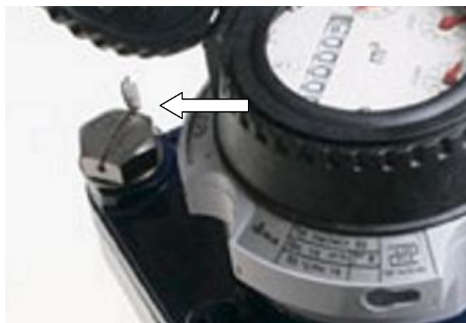
Рисунок 3 – Схема пломбировки от несанкционированного доступа, обозначение места нанесения знака поверки счетчиков холодной воды комбинированных Meitwin
