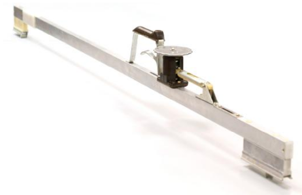
Рисунок 1 - Фотография общего вида шаблона путеизмерительного ЦУП-3
