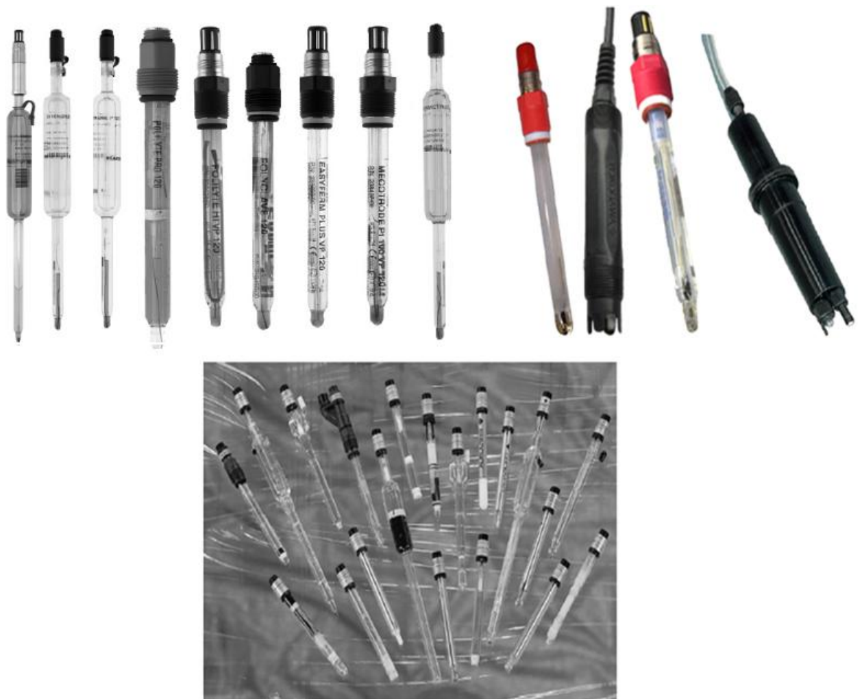
Рисунок 2 - Внешний вид сенсоров pH.
