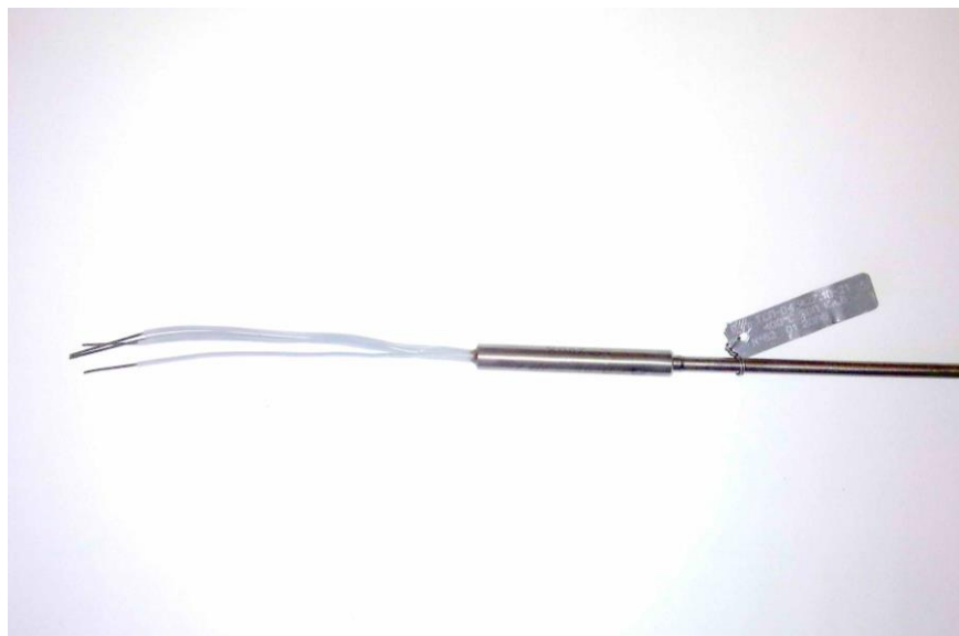
Рисунок 1 – Общий вид термопреобразователей сопротивления ТСП-04
