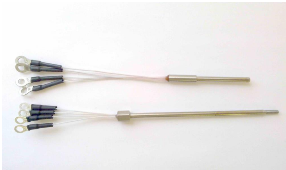
Рисунок 1 - Общий вид термопреобразователей сопротивления ТСП-06
