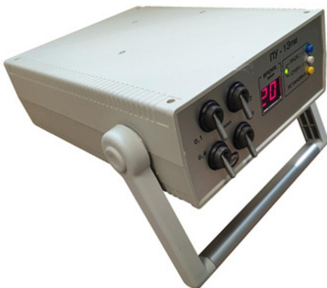
Рисунок 1 - Общий вид аспираторов
