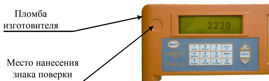
Рисунок 6 - Схема пломбирования расходомеров Portaflow 300
