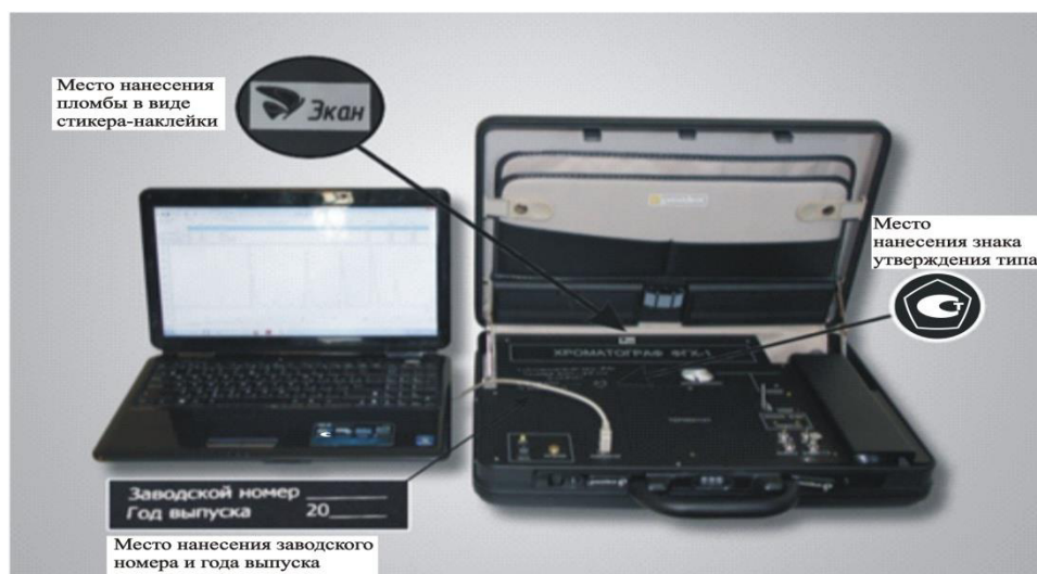
Рисунок 1 - Общий вид хроматографа газового портативного ФГХ, переносной вариант.
