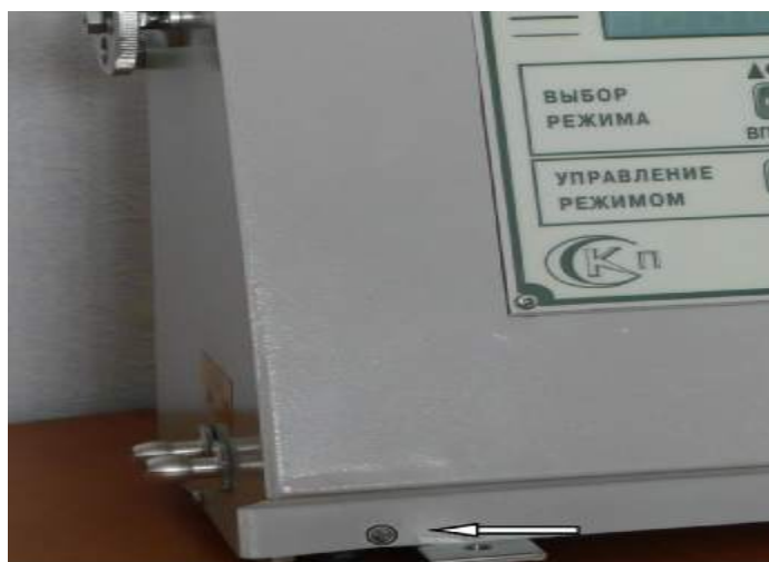
Рисунок 2 – Место пломбирования автоматических лабораторных приборов АЛП
