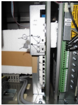
Рисунок 8- Место пломбирования электронного счетного устройства ER5
