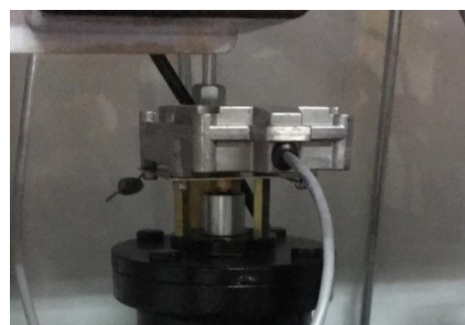
Рисунок 5- Место пломбирования расходомера объемного
