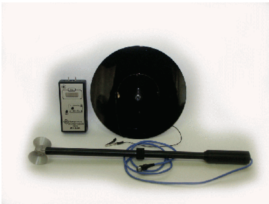
Рисунок 1 – Общий вид измерителя электрического поля ИЭП-05
