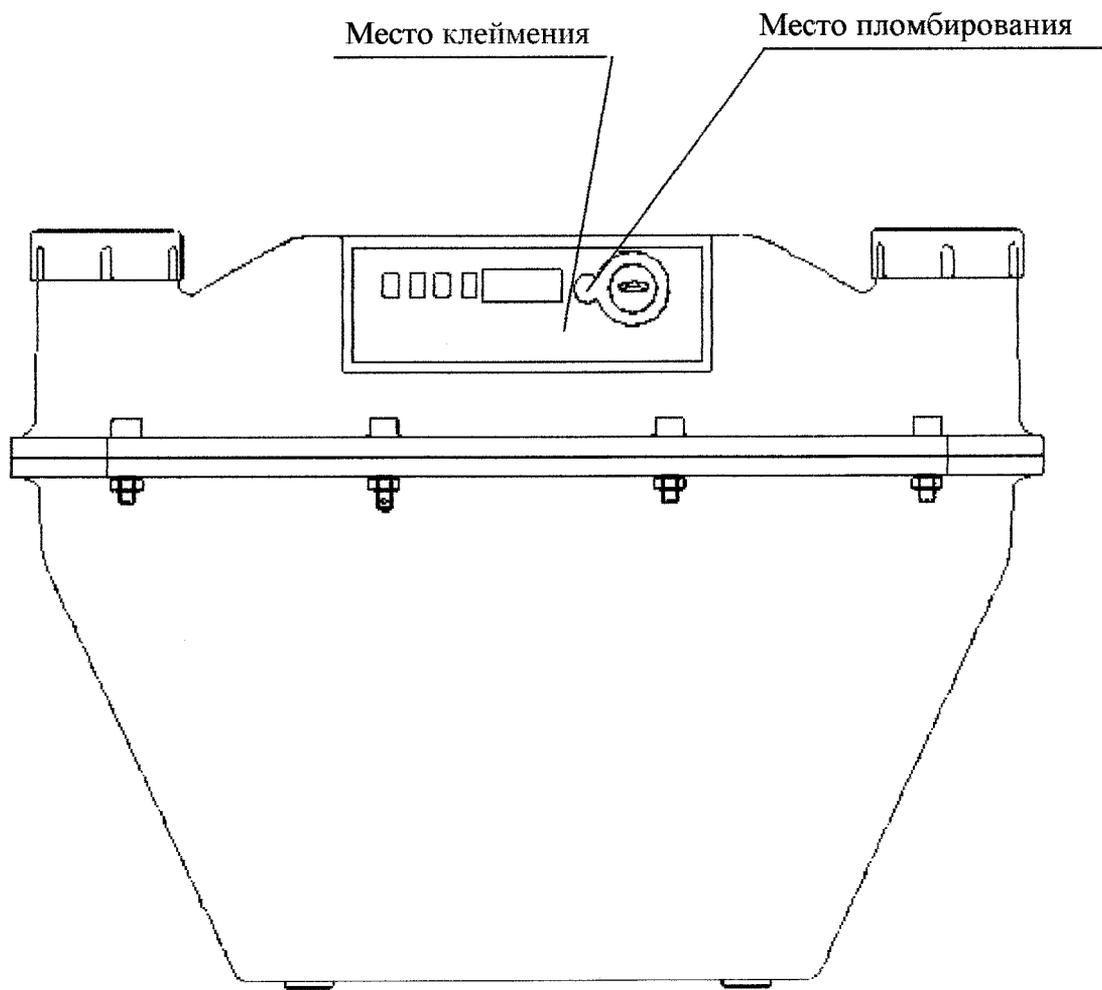
Рисунок Б2 - Счетчики газа мембранные СГМ-2-2-1; СГМ-2-3-1;
