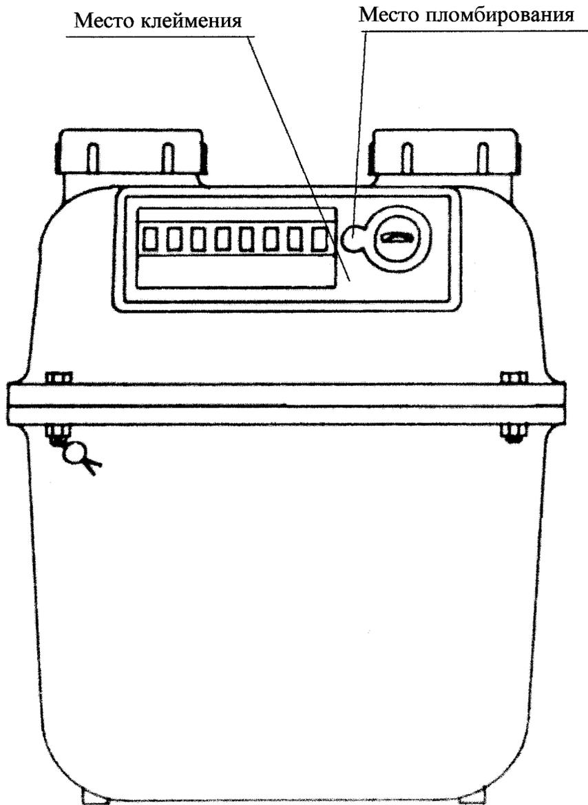
Рисунок Б1 - Счетчики газа мембранные СГМ-1-1-1
