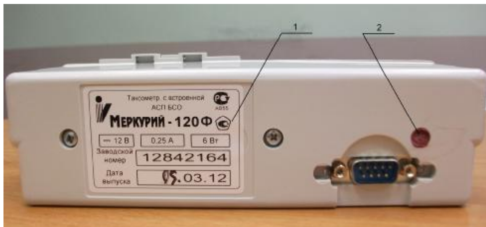
Рис.2. Место нанесения знака утверждения типа (1) и место пломбирования (2)
