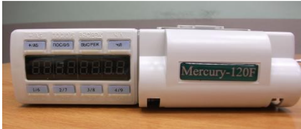
Рис. 1. Общий вид таксометров «Меркурий-120Ф», «Меркурий-120К»
