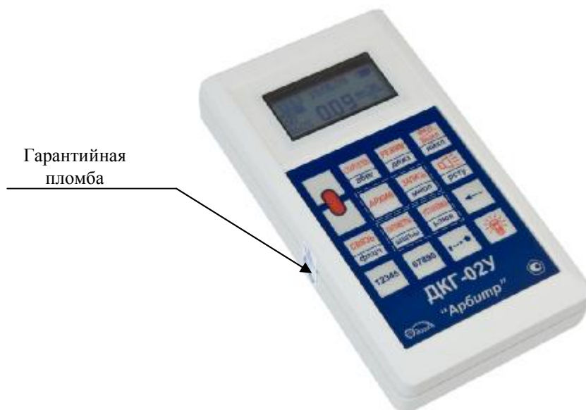
Рисунок 1 – Общий вид и место пломбировки дозиметра
