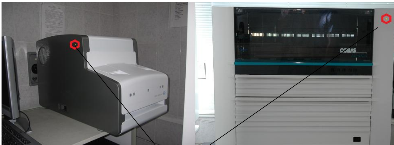
Место нанесения знака утверждения типа
