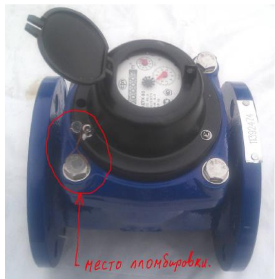
Рисунок 2 – Места пломбирования счетчиков
