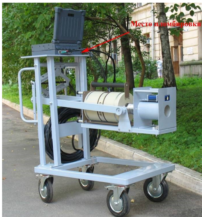
Рисунок 3 – Общий вид комплекса в мобильном исполнении с полупроводниковым гамма-трактом на основе азотного охлаждения с портативным сосудом Дьюара в комплекте с транспортным устройством.
