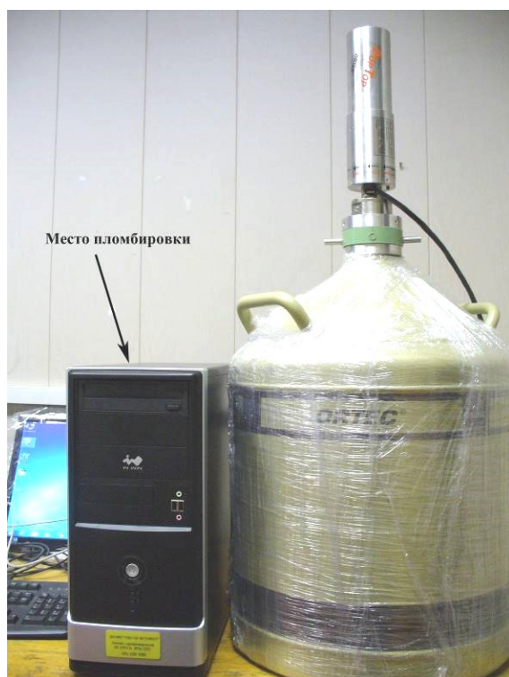
Рисунок 4 – Общий вид комплекса в лабораторном исполнении с полупроводниковым гамма-трактом на основе азотного охлаждения в сосуде Дьюара (а) в комплекте с низкофоновой защитой (б).
