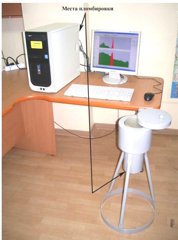
Рисунок 2 – Общий вид комплекса в лабораторном исполнении со сцинтиляционным гамма-трактом в комплекте с низкофоновой защитой.
