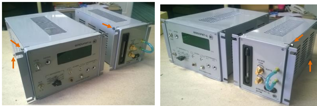
Рисунок 2 - Газоанализатор ФЛЮОРИТ-Ц. Блок измерения. Датчик. Схема пломбирования от несанкционированного доступа
