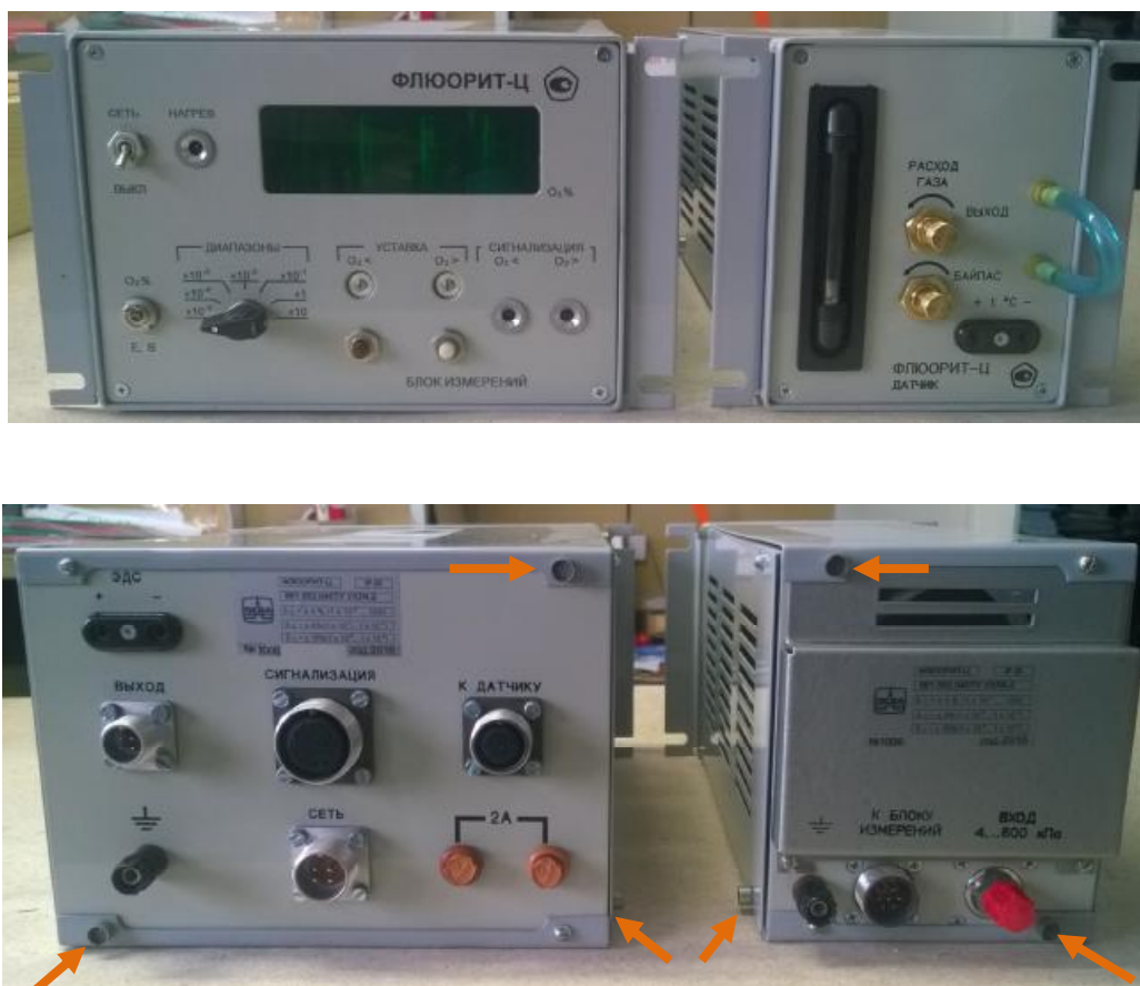
Рисунок 1 - Газоанализатор ФЛЮОРИТ-Ц. Блок измерения. Датчик. Схема пломбирования от несанкционированного доступа
