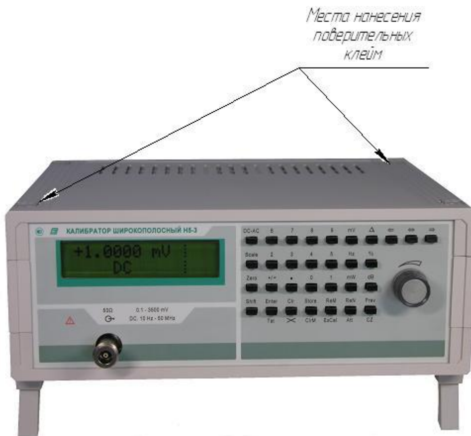
Рисунок 2 - Места нанесения поверительных клеев
