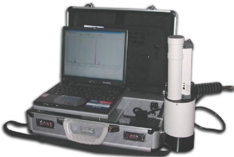
Рисунок 1 - Внешний вид анализатора «Призма» в переносном варианте исполнения
