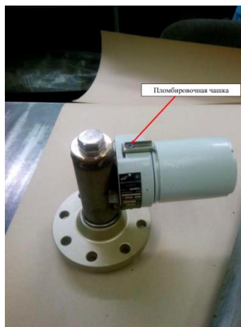
Рисунок 2 - Схема пломбировки от несанкционированного доступа
