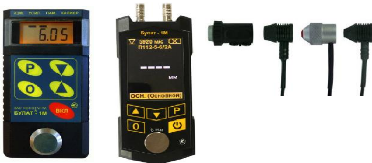
а) блок обработки информации с двумя элементами питания, б) блок обработки информации со встроенной Li-Ion аккумуляторной батареей, в) преобразователи Рисунок 1 – Общий вид средства измерений
