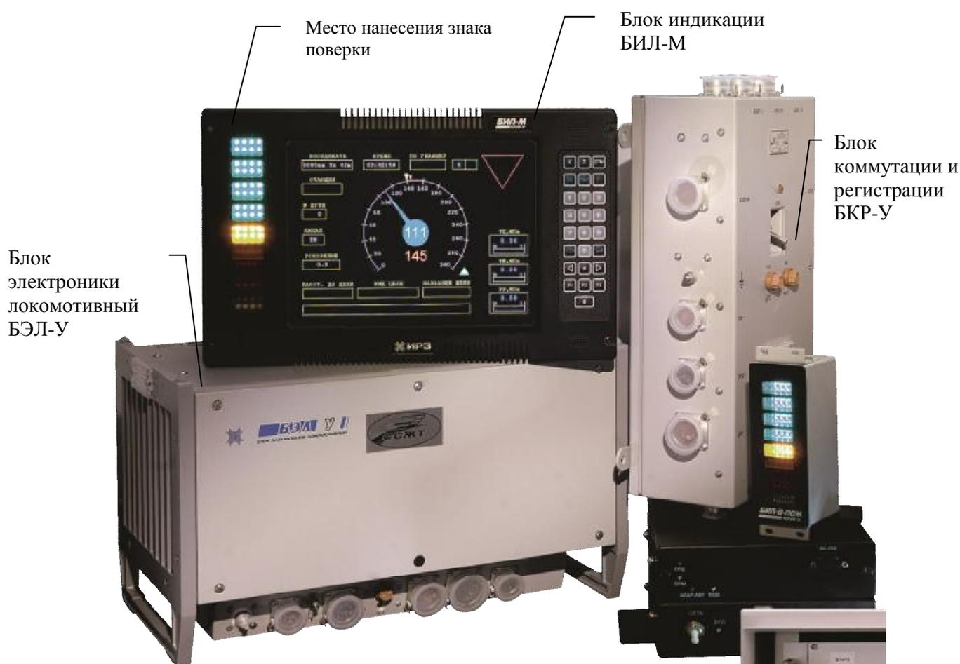
Рисунок 3 - Общий вид измерителя скорости и давления электронного локомотивного
