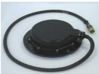
Рисунок 1 - Датчик угла поворота ДПС-У
