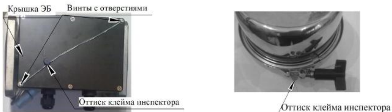
Рисунок 6 – Места пломбирования электронного блока компактного исполнения (клеммной коробки ППР) и электронного блока исполнения IP68
