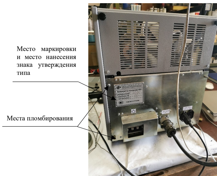
Рисунок 2 – Место маркировки и место нанесения знака утверждения типа анализаторов водорода АВ-1, модификации «АВ-1», «АВ-1-01», «АВ-1-02»; места пломбирования анализаторов водорода АВ-1, модификации «АВ-1», «АВ-1-01»
