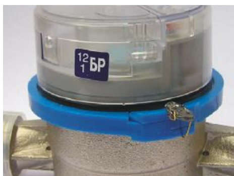
Рисунок 2 - Схема мест пломбировки счетчика Volumex VLX 1,5/40
