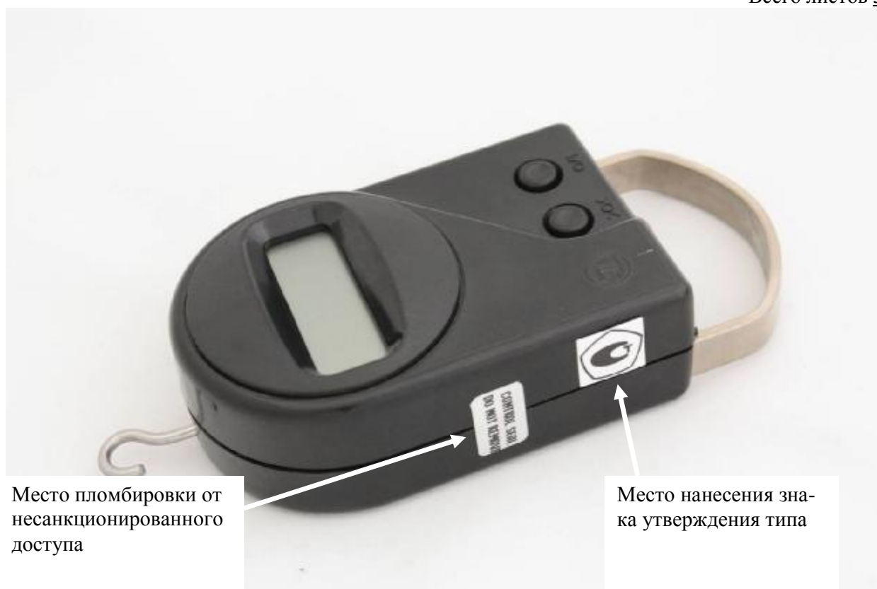
Рисунок 2. Схема пломбирования от несанкционированного доступа.
