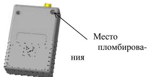
Рисунок 5 - Место пломбирования и нанесения оттиска клейма мониторов МнСДП-1 и МнСДП-3
