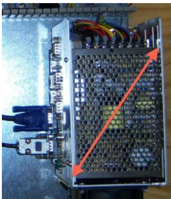
Рис. 2 – Место нанесения контрольного знака на корпусе блока обработки и отображения информации.
