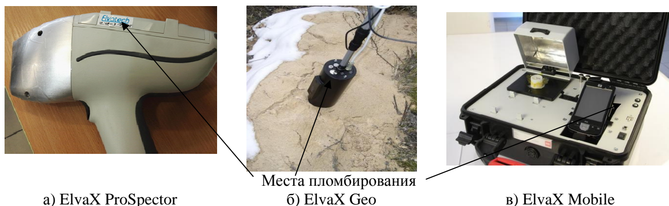
Рисунок 3 - Общий вид спектрометров СЕР-01 (модификации ElvaX ProSpector, ElvaX Geo и ElvaX Mobile) с указанием мест пломбировки от несанкционированного доступа
