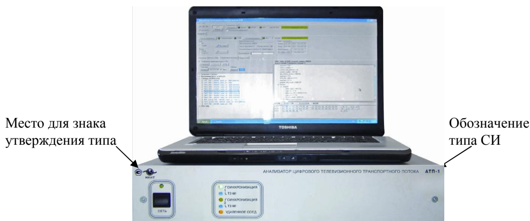
Рисунок 1- Общий вид АТП-1 с ПК
