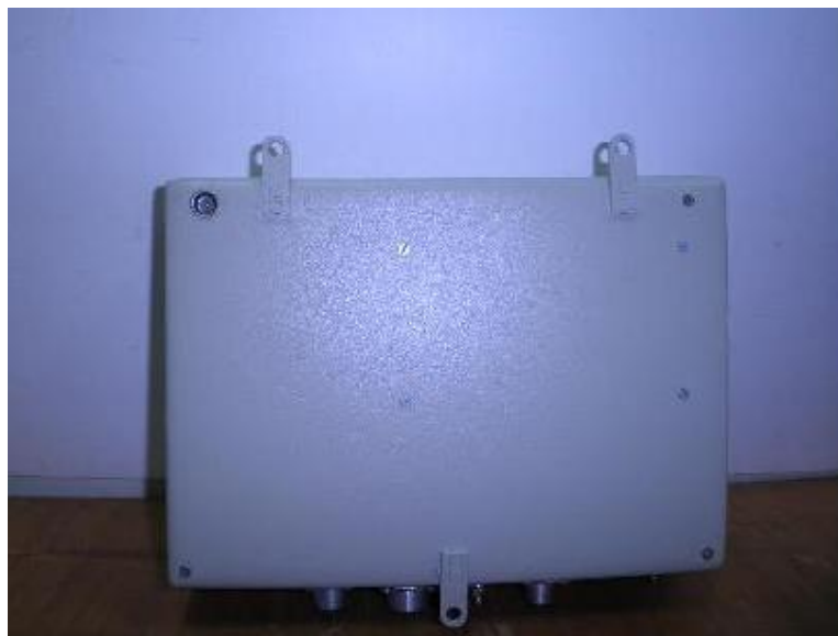
Рисунок 3 –Место пломбирования блоков от несанкционированного доступа.
