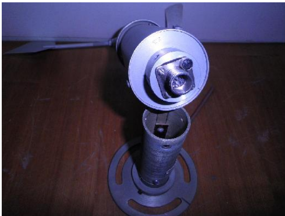
Рисунок 4 – место пломбирования ДСНВ от несанкционированного доступа.
