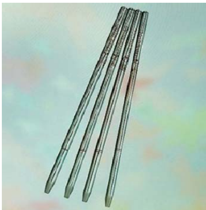
Рисунок 1 - Общий вид пипеток прямых стеклянных (типа Сали) ППС-01-20
