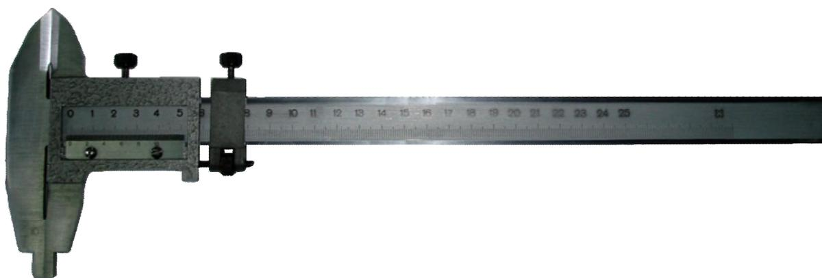
Рисунок 1 - Внешний вид штангенциркуля типа ШЦ-II
