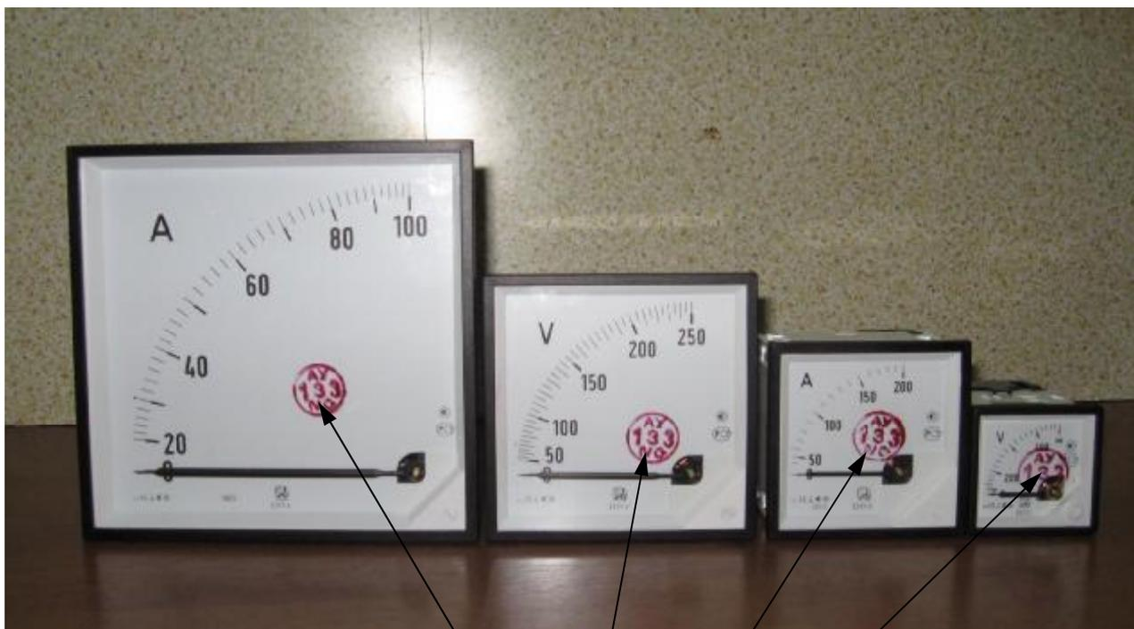
Рисунок 2 - Места нанесения поверительных клейм
