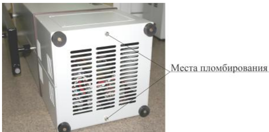
Рисунок 2 – Схема пломбировки от несанкционированного доступа
