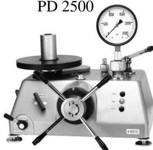
Рисунок 1 – Общий вид манометров избыточного давления грузопоршневых PD
