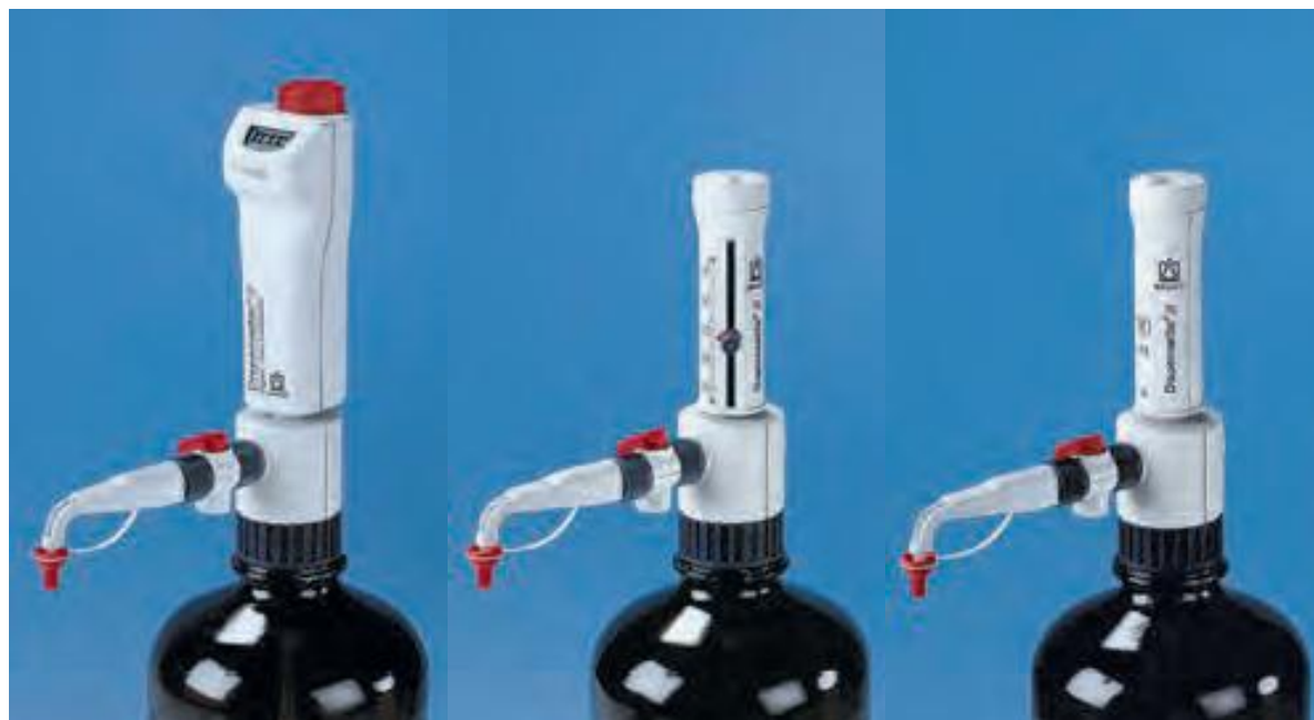
Рис. 1 Внешний вид дозаторов DISPENSER модификации Dispensette® III с цифровым индикатором, аналоговой шкалой и с фиксированным объемом.
