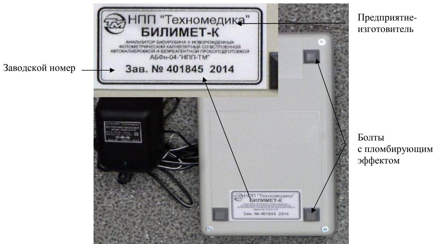
Рисунок 2 – Схема маркировки и пломбировки
