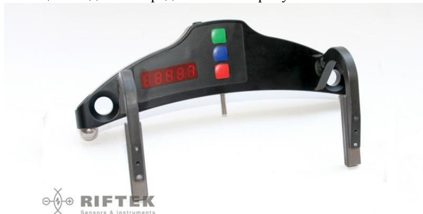
Рисунок 1 – Общий вид скоб измерительных диаметров колесных пар ИДК
