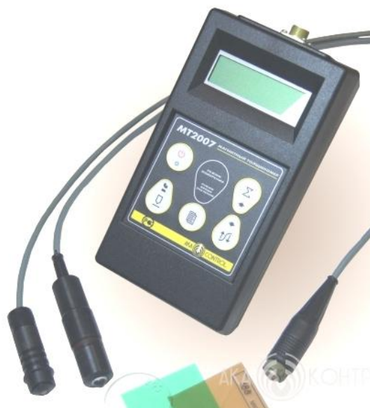
Рисунок 1 – Внешний вид толщиномера покрытий магнитного МТ2007.
