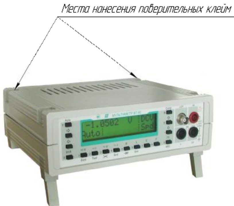
Рисунок 2 - Места нанесения поверительных клеев
